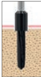
3 Calibratura del diametro del sito implantare con la fresa a finire calibrata
