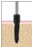
7. Calibratura del diametro definitivo del sito implantare con la fresa a finire
