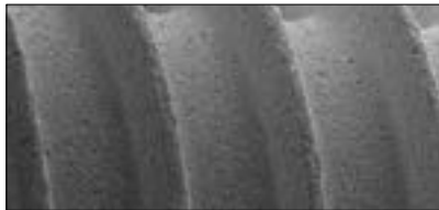
Particolare al SEM (100 X) della filettatura di un impianto Multysystem® con trattamento di superficie R.A.F.
