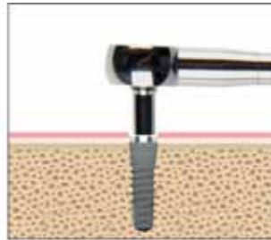
2. Înșurubarea implantului TC/CC Multysystem® cu clichetul complet cu adaptor
